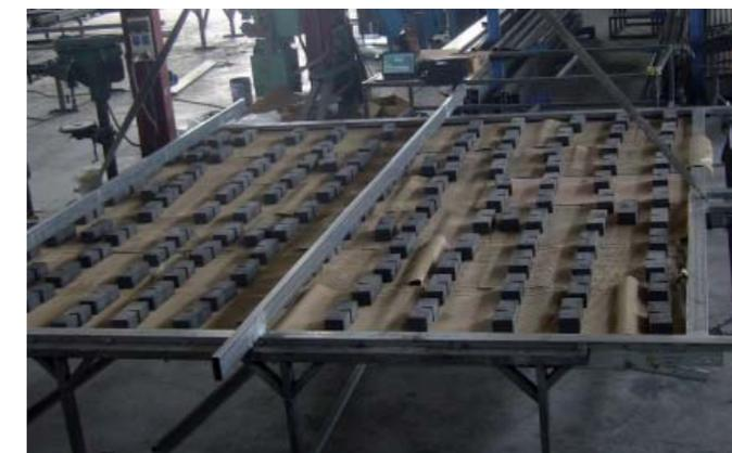
Imagen 30. Ejemplo de ensayo de Resistencia al viento.
